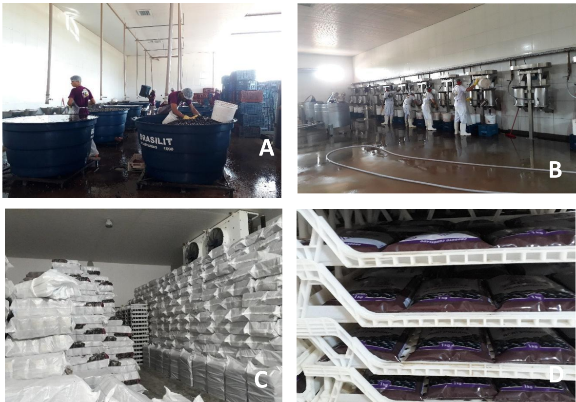
Figura 3 – (A) Lavagem e seleção do produto, (B) Despulpamento nas bateadeiras, (C) Embalagem do produto, (D) Congelamento na Câmara fria.
