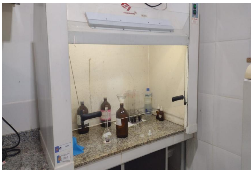
Figura 3: capela de exaustão
