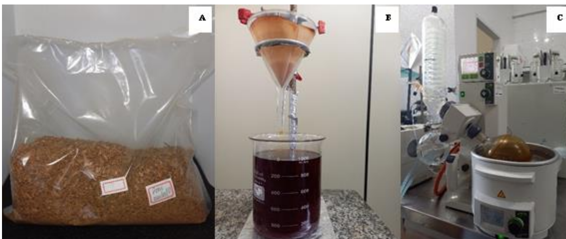
Figura 1. A - Amostra da casca do caule triturada. B – Filtragem do extrato após banho ultrassom. C – Secagem do extrato hidroalcolólico por rotaevaporação. Fonte: os autores
